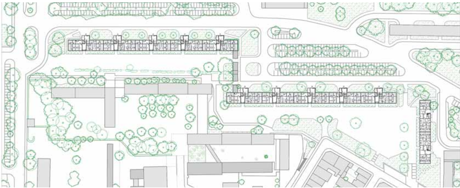
Das Projekt verteilt sich auf zwei Gebäuderiegel mit jeweils 225 Wohneinheiten und einem kleineren, quer stehenden Riegel mit 80 Einheiten. Ursprünglich erwog die Stadt den Abriss. Der Lageplan zeigt das Erdgeschoss der drei Gebäuderiegel ohne Ergänzungen. Lageplan im Maßstab 1:2000
