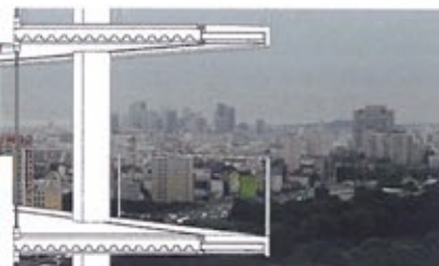
Extensión en fachada mediante la adición de un módulo prefabricado de 3 metros de anchura
